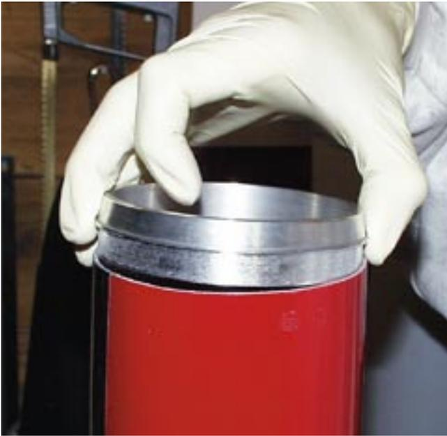
Zuerst wird der Außenring in das größere Rumpfteil (meist der Bug) eingeklebt. Dabei sollte nach Möglichkeit der Innenring drin stecken, um den recht dünnen Ring sicher kreisförmig zu halten. Äußerste Vorsicht ist geboten, damit nicht Klebharz zwischen die Ringe läuft und die unwiderruflich verbindet.
