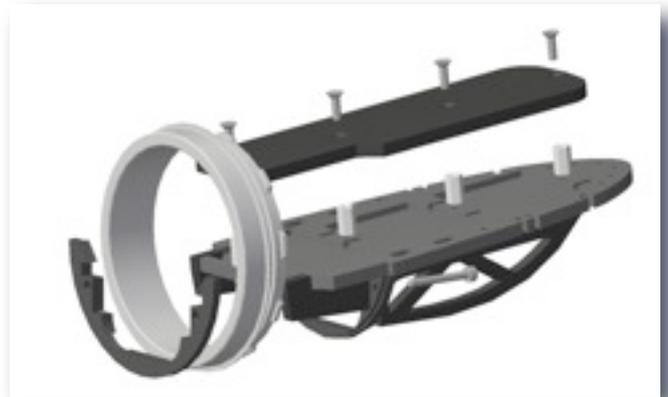
Der Einbaurahmen wird aus den Teilen 4.1 bis 4.3 zusammengeklebt.
