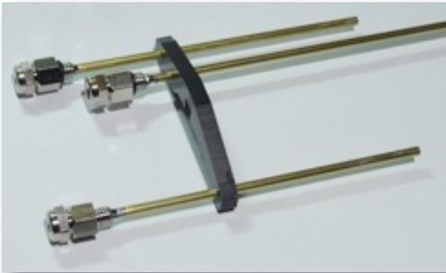
Die Bohrungen im Rumpf kann man vom Plan übernehmen. Um sie passgenau auszuarbeiten hat sich eine dünne Rundfeile (= Sägekettenfeile) bewährt.
