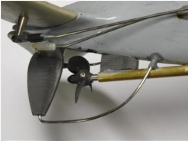
Die Achse ist der achtere Teil des Propellerschutzbügels. Der wird vorne von einem kleinen Rohrstück neben dem Stevenrohr gehalten. Achtern sitzt er in einer Bohrung im Rumpffende und wird von der Seite mit einer Madenschraube fixiert.
