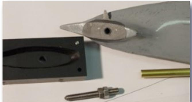
Wenn die Gewindebuchsen gut eingeklebt sind, kann zur Erhöhung der Stabilität das Ende des Rumpfes mit Epoxidharz vergossen werden.
