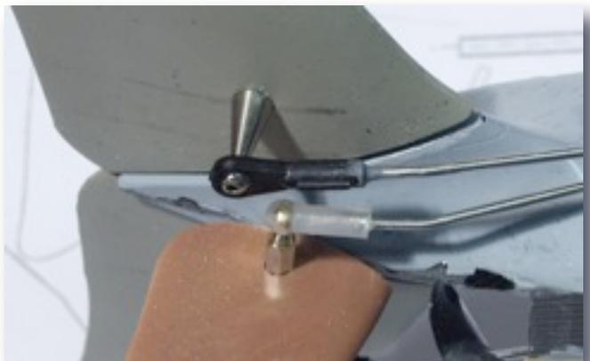
Für das Seitenruder ist ein kleinerer geschlossener Kugelkopf vorgesehen. Bei ihm wird der Schaft aus einer Gewindehülse und einem kurzen Kugelbolzen aufgebaut. Dem Teil eine stromlinienform zu feilen kann nicht schaden, insbesondere wenn man höhere Geschwindigkeiten im Auge hat.
