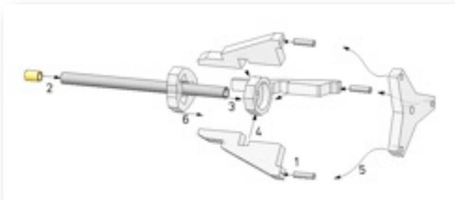
Vorher werden die Gewindebolzen in zu bohrende M3-Löcher eingedreht und -geklebt. (statt 2,5er Kernloch bohren und Gewindeschneiden geht auch 2,75er Loch bohren und Schraube eindrehen) Das Sternförmige Teil wird beim Kleben des Dreibeins als Schablone verwendet.
