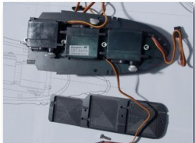
Das Oberdeck wird mit M3 Senkkopfschrauben und Langmuttern befestigt und hält die Servos in Position. Die Senkungen für die Schrauben bei Bedarf nacharbeiten.
