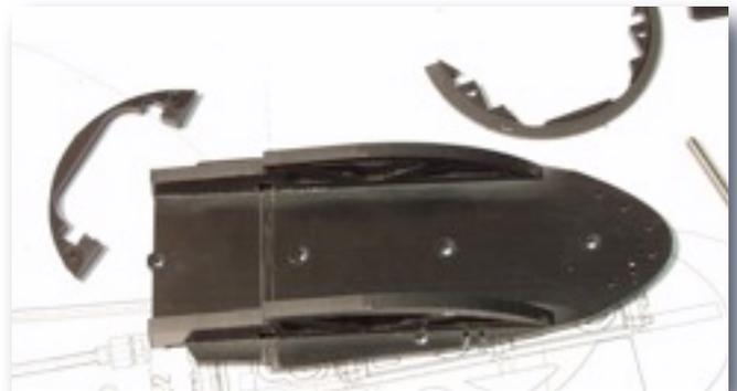
Der Spant 4.3 muss vorher noch passend schräg gefeilt werden. Das Standart-Deck ist für Graupner Servos der Baureihen C507, C577, DS8077 und DS8025 ausgearbeitet. Für andere Abmessungen gibt es ein Alternativbauteil. Dabei muss allerdings noch für eine sichere Befestigung der Servos gesorgt werden.
