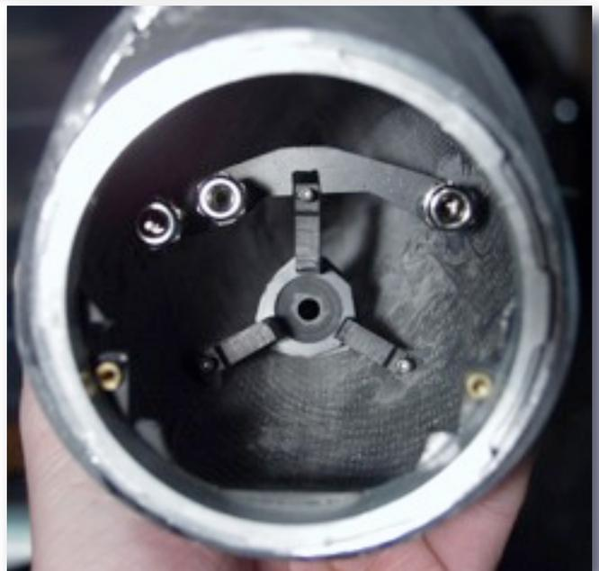
Der Motor wird mit der Welle, der Kupplung und dem Flansch mit eingepresstem Wellendichtring vormontiert und dann mit einem O-Ring als Zwischendichtung auf das Dreibein geschraubt.
