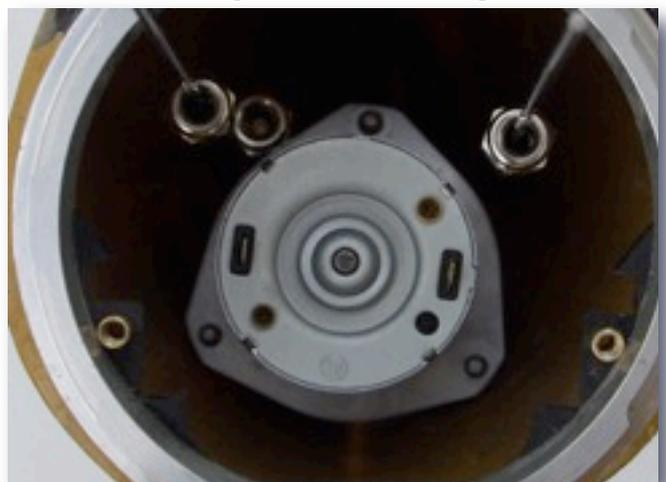
Alternativ zu dem beiliegenden 500er Motor können natürlich auch elektronisch kommutierte (bürstenlose) Motore eingebaut werden.
