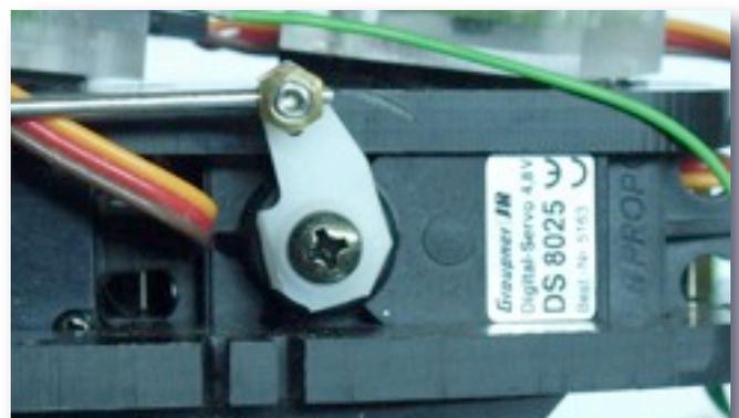
Die Servoseiten werden mit den Gestängeanschlüssen befestigt. Das ist lösbar und einstellbar.
