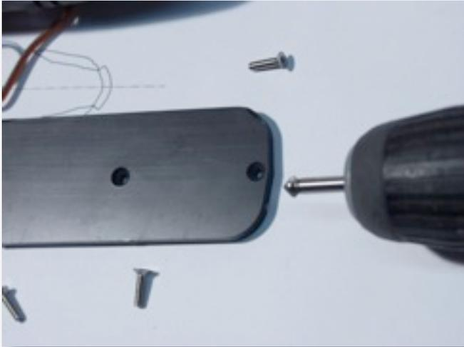
Der Rahmen wird im Rumpf festgehalten mittels eines weiteren Halbspants (4.4). In diesen werden die Einpressmuttern (29) eingesetzt und der Überstand der Köpfe beigefeilt. Der Halbspant wird an den Bajonettverschluss geklebt.
